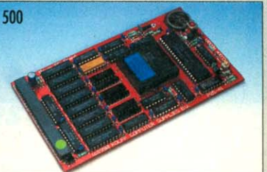
Power PC-Board 798 DM Der Geheimtipp: Ihr AMIGA® 500 IBM-kompatibel! Alle AMIGA® Ein- und Ausgänge werden unterstützt: Maus, Joystick, int.+ext. (auch 5,25 Zoll) Laufwerke, par./ser. Schnittstelle, 1 MByte Ram und Uhr auch für den AMIGA® 500 ansprechbar, NORTON SI-Faktor 3,3
