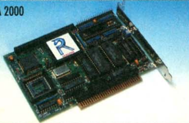
386-si Power Board 1298 DM verwandelt Ihre XT-Karte ruckzuck in einen 386-SX 16 MHz Taktfrequenz und 16 KByte CACHE-Speicher für höchste Geschwindigkeit: macht die XT-Karte bis zu 12x schneller (NORTON SI-Faktor 11,5)! Steckplatz für 387-SX-Coprozessor
